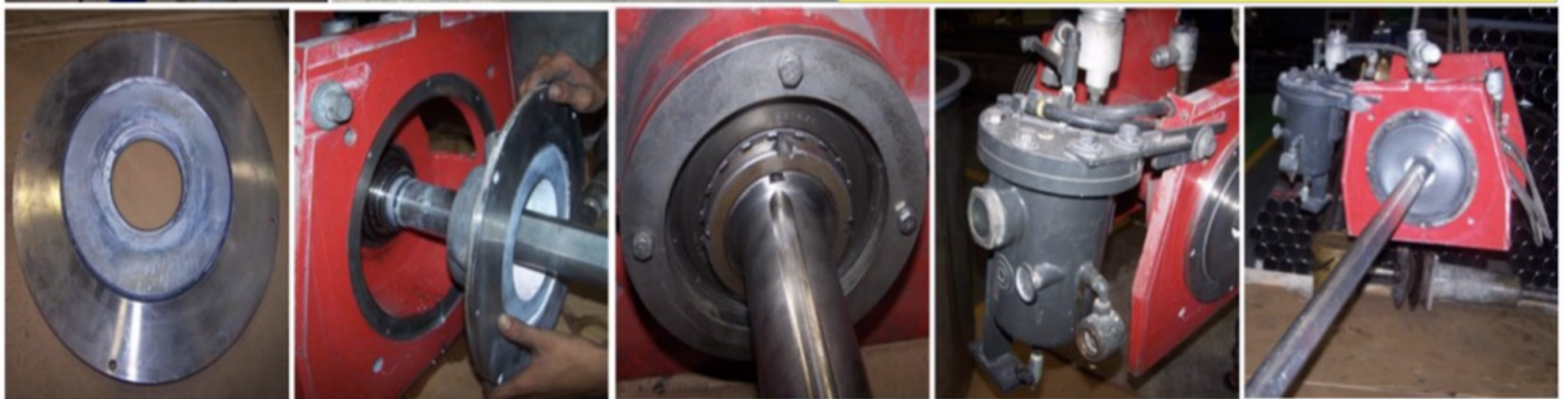
งานซ่อมเครื่องบดPremier USA ชัดMechanical Seal และ Carbide Sieve Ring
