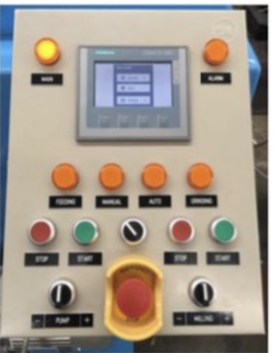
เครื่องบดสารเคมีควบคุมอัตโนมัติ ระยะไกลผ่านระบบProfibus
